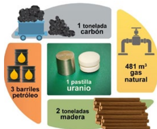
Figura 4. Equivalencia de la energía de una pastilla de UO 2 comparada con otros combustibles fósiles.
